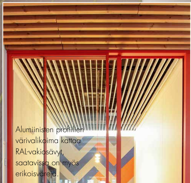
Liukuovi on alakantoinen kapealla kynnyksellä. Mahdollisuus saada myös levennetyllä kynnyksellä.
